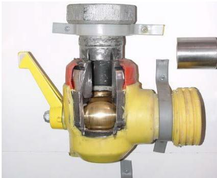
Der Austritt der Hauptabsperreinrichtung stellt den Beginn der Kundenanlage dar (Ausnahme: installierter Mitteldruckregler).
